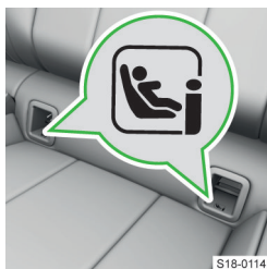
Проушины для установки детского сиденья с системой ISOFIX.
